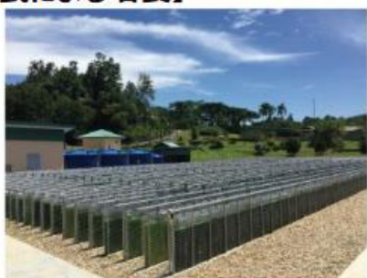
閉鎖系培養方法：フォトバイオリクター 設備保有者/Sarawak Biodiversity Centre (出所) ちとせ研究所HP
